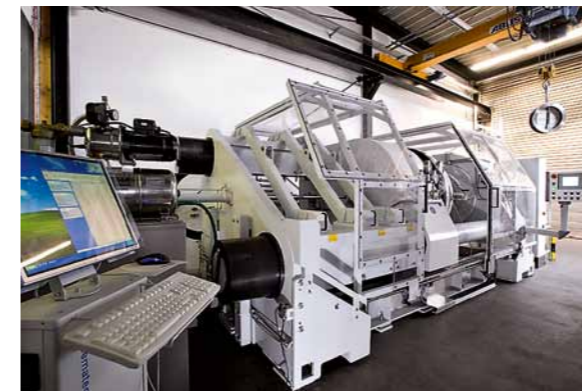
■ RITAG Rückschlagarmatur vom Typ ZRD API 24" vor der Prüfung RITAG check valve, type ZRD API 24", before testing
