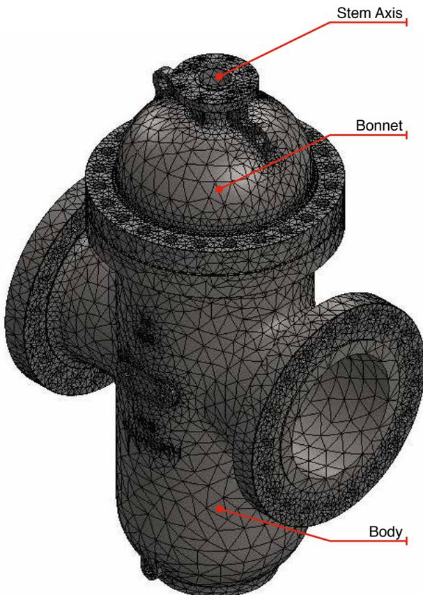
FINITE ELEMENT MODEL OF GATE VALVE
